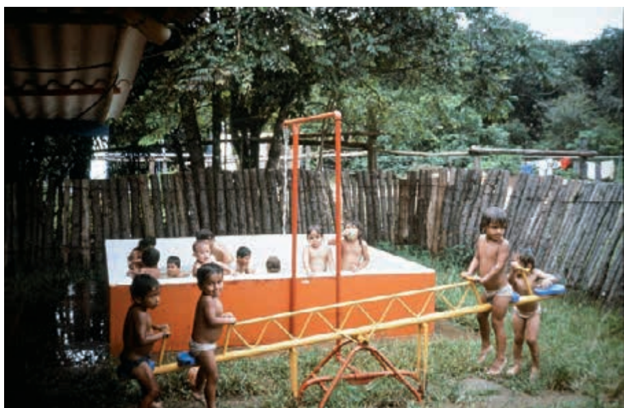
Balancín GAVIOTAS para elevación de agua
