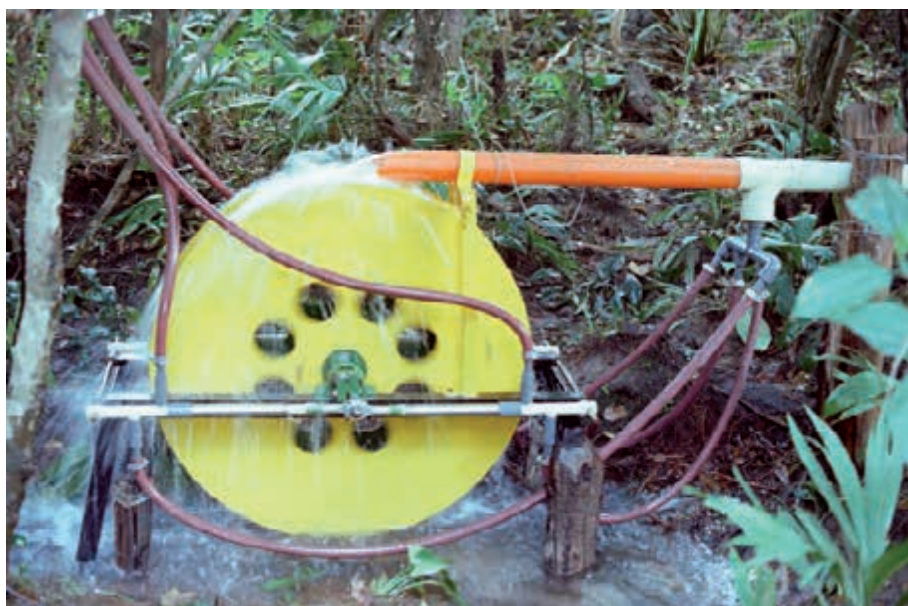
Rueda hidráulica GAVIOTAS para elevación de agua
