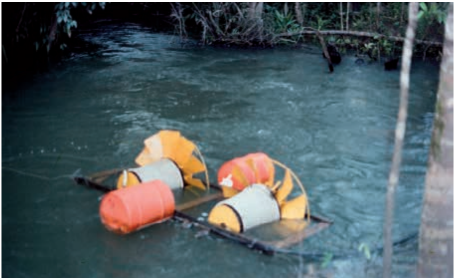
Bomba hidrostática GAVIOTAS para elevación de agua
