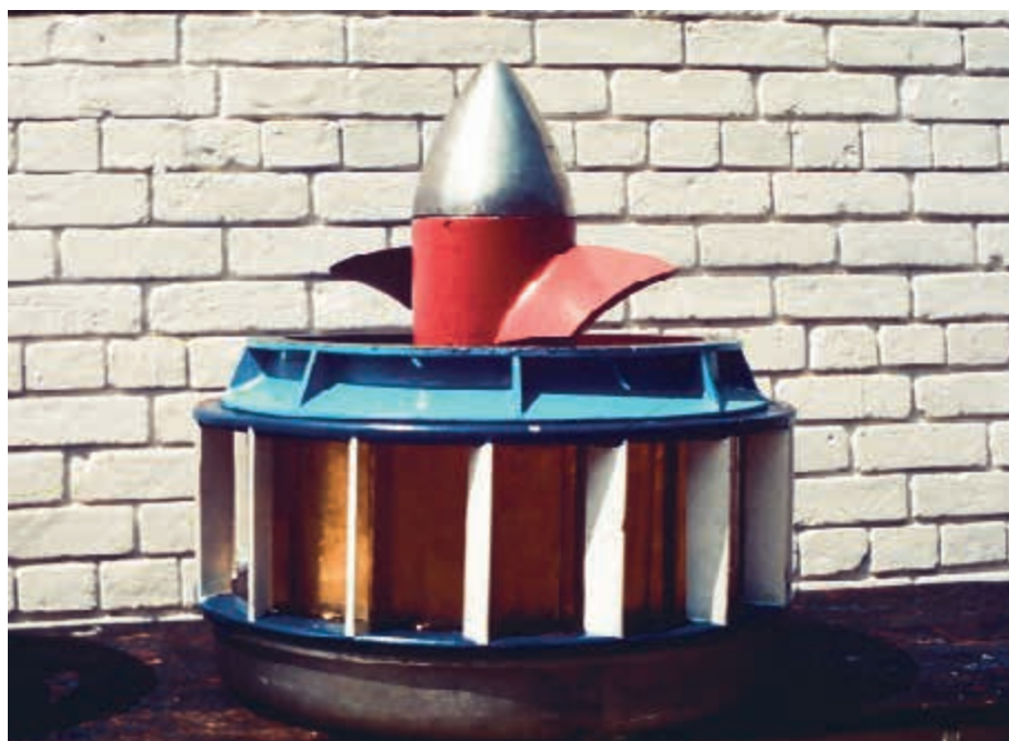
Turbina hidráulica GAVIOTAS de baja caída para generar electricidad
